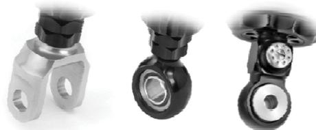
Monoammortizzatore disponibile in varie conformazioni per un migliore adattamento ai vari modelli di moto. Molla in lega di Acciaio CrMb disponibile in diverse costanti elastiche, in base al modello di moto e peso pilota. Tutti i componenti in alluminio sono con trattamento di ossidazione anodica.
