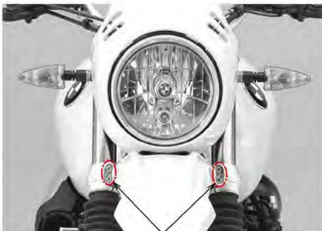
**⚠ ATTENZIONE:** RIMUOVERE LE VITI ORIGINALI E COMPLETARE IL MONTAGGIO DELLA PIASTRA DI UN LATO PRIMA DI INIZIARE LO SMONTAGGIO DELLE VITI ORIGINALI DELL'ALTRO LATO.
